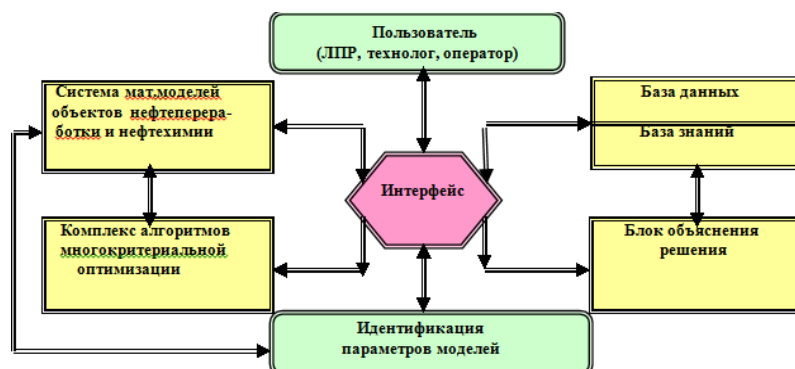
Рисунок 1. Структура системы КМО режимов технологических объектов нефтепереработки и нефтехимии путем математического моделирования их работы
