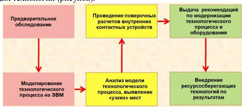
Рисунок. Схема, иллюстрирующая этапы технологического аудита химико-технологического процесса.
